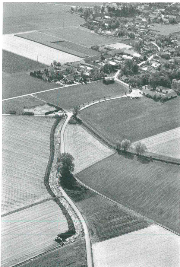
Abb. 12: Buchhofen-Nindorf. Das Luftbild vom 5. 10. 1993 zeigt den laufenden Humusabtrag an der Wasserleitungstrasse unmittelbar links der von Nindorf her kommenden Asphaltstraße.
